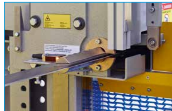
Winkelverstellung des Bandmessers (S 20 bis S 36).
