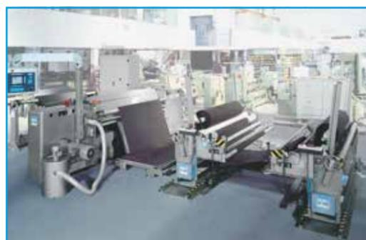
Máquina de dividir G 11 con dispositivo enrollador y desenrollador
